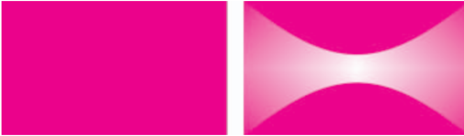
Bild 2: Fallunterscheidung: Fall A (links) Probe im Ausgangszustand, homogene Absorberverteilung ohne Anregungslaser und Fall B (rechts) Probe mit eingeschaltetem Anregungslaser, inhomogene Absorberverteilung durch induziertes Ausbleichen des Grundzustandes
