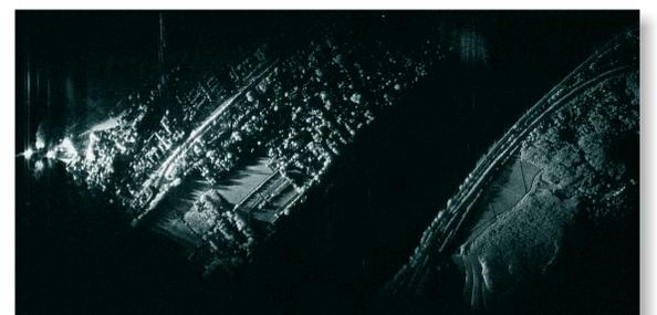
Bistatisch prozessiertes SAR-Bild
