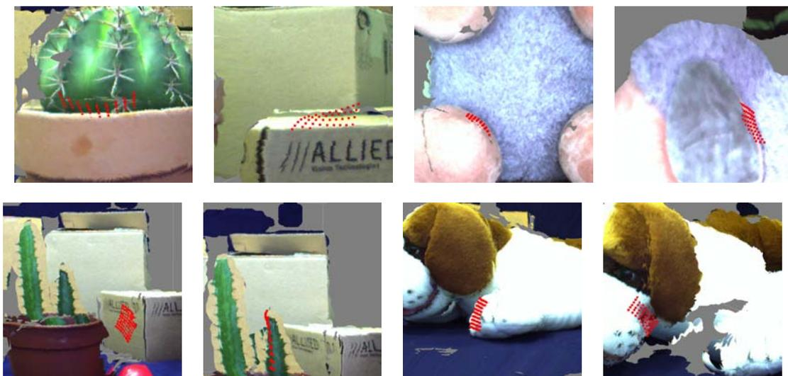
**Abbildung 10.1.:** Durch die Generierung von zusätzlichen Punkten (im Geometry Shader) wird pro Szene jeweils ein lokales Polynom in einem Punkt dargestellt. Als Punktgröße wurde 5.0 gewählt.
