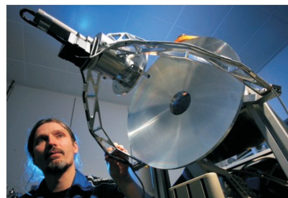
Supraleitendes Mikrobolometer Imaging System bei T = 300mK (IPHT Jena)
