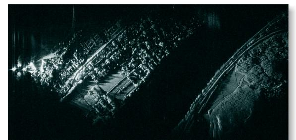
Bistatisch prozessiertes SAR-Bild
