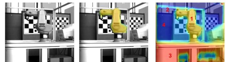
Abstände: (1) Roboter = 3,0m (2) Rahmen = 3,6m (3) Vordergrund = 2,1m (4) Hintergrund = 6,0m
