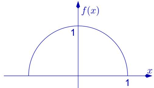
**Implizite Repräsentation:** Definition einer  $n - 1$ -dim. Geometrie in einem  $n$ -dim. Raum über Auswertung einer Funktion  $f : \mathbb{R}^n \rightarrow \mathbb{R}$  ( $n = 2$ : Kurve,  $n = 3$ : Fläche) zu einem Isowert  $a$ :
