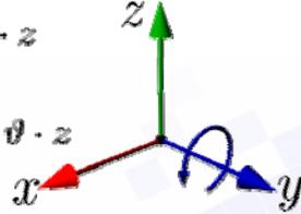
$$\mathbf{R}_y(\vartheta) = \begin{pmatrix} \cos \vartheta & 0 & \sin \vartheta & 0 \\ 0 & 1 & 0 & 0 \\ -\sin \vartheta & 0 & \cos \vartheta & 0 \\ 0 & 0 & 0 & 1 \end{pmatrix}$$
