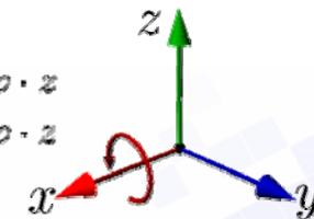
$$\mathbf{R}_x(\varphi) = \begin{pmatrix} 1 & 0 & 0 & 0 \\ 0 & \cos \varphi & -\sin \varphi & 0 \\ 0 & \sin \varphi & \cos \varphi & 0 \\ 0 & 0 & 0 & 1 \end{pmatrix}$$
